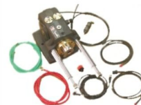
Kit cam box para testeo de sistema UIS/PLD - Completo con todos accesorios necesarios. Dispositivo autónomo
